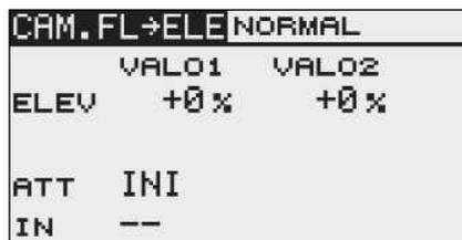
Il primo passo consiste nell'attivare la miscelazione alla riga "ACT/INA". Selezionare l'impostazione mediante comando "CAP TOUCH", quindi confermare la scelta premendo "RTN". In base alla posizione occupata dall'interruttore comparirà la scritta "ON" (attivo) o "OFF" (disattivato).
