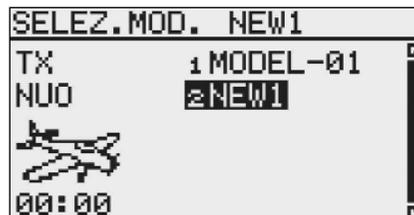
Selezionare il Menu "SELEZIONE MODELLO" ("MODELL-WAHL"), poi scegliere mediante comando "CAP TOUCH" la destinazione : "INTE" per recuperare dati contenuti nella memoria interna della trasmittente, oppure "CARD" per quelli contenuti nella scheda SD.
