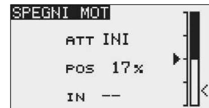
Attivare la funzione evidenziando il campo ACT/INA: poi modificare mediante il comando "CAP TOUCH", la voce „INA“ portandola a "ACT" oppure "ON", in funzione della posizione occupata dall'interruttore designato. Premere "RTN" al termine dell'operazione.
