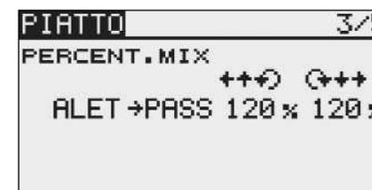
Di seguito si regolano i valori di miscelazione per le funzioni elev (ELEV -> ALET und ELEV -> PASS). Si possono regolare valori percentuali separati per entrambe le escursioni. Eseguire la regolazione facendo in modo che la funzione Nick non ostacoli quelle di Pitch o Roll lungo l'intera corsa.
