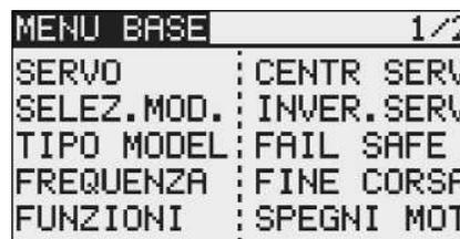
Il menu base è suddiviso in due schermate per poter ospitare tutte le funzioni messe a disposizione; per passare da una a quella successiva (o viceversa) è sufficiente premere il tasto S1. Ruotando il comando "CAP TOUCH" oltre l'ultima posizione, si accede automaticamente alla pagina seguente. La seconda parte del menu base si compone come illustrato di seguito:
