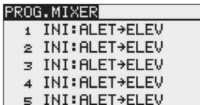
Ciascuna riga nel menu riporta una miscela, per un totale complessivo di 5 miscele. Di seguito viene descritta la modalità di programmazione per la miscela nr. 1; le restanti (2-5) si programmano allo stesso modo.
