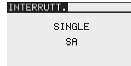
Per passare da una condizione di volo all'altra è possibile impostare un singolo interruttore (Single), oppure stabilire una combinazione logica tra due interruttori (Logic).
