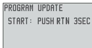
Seguire l'indicazione e mantenere premuto il tasto "RTN" per almeno 3 secondi. Qualora sia stata inserita una scheda difettosa o sprovvista di software di aggiornamento (oppure se non è stata inserita nessuna scheda), apparirà la seguente notifica:
