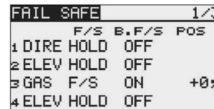
Il menu dispone complessivamente di 3 pagine (come mostrato in alto a destra sul display), per poter visualizzare anche i canali 5 fino a 8. Scegliere quindi con il comando "CAP TOUCH" il canale per cui si desidera modificare l'opzione Failsafe. E' sufficiente ruotare verso sinistra la manopola "CAP TOUCH" per modificare l'opzione da "HOLD" a "F/S". Una volta effettuata la selezione desiderata, premere il tasto "RTN" per conferma.
