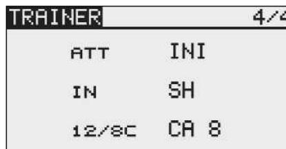
Una volta configurate le opzioni di base, l'utente può determinare singolarmente per ciascun canale se azionarlo da solo, oppure insieme al maestro, una volta effettuato il passaggio dei comandi. Le modalità possono essere impostate separatamente per ogni funzione, oppure è comunque possibile anche una combinazione di modalità per le differenti funzioni.
