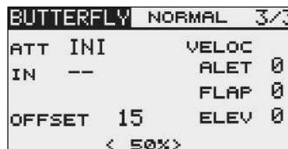
Il menu principale della miscelazione Butterfly mette a disposizione in base al tipo di modello e di configurazione alare selezionati - fino a due alettoni, due flap e due aerofreni. Dal menu principale è possibile accedere al menu di regolazione ed a quello di programmazione per le escursioni del timone di profondità.
