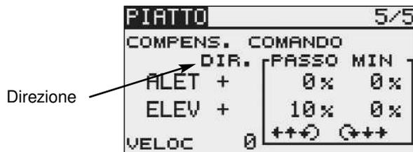
La schermata 5/5 del menu di impostazione del piatto ciclico offre anche la possibilità di regolare una velocità di bilanciamento (SPEED). Portare lo stick di comando del gas sulla trasmittente a metà corsa. Muovere ora lo stick di comando del Nick in maniera rapida. Regolare ora il valore percentuale della velocità in modo da evitare oscillazioni della funzione di pass.
