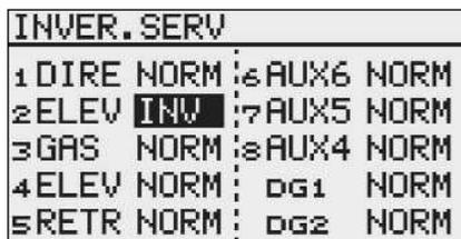
Per ciascun servo verrà visualizzato sul display il verso di rotazione che può essere "NORM" oppure "REV" (invertito).
