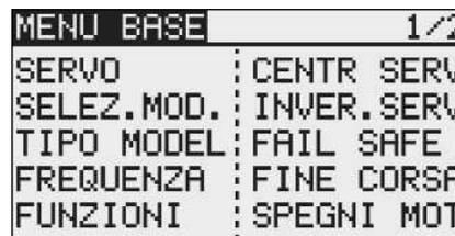
Il menu base è suddiviso in due schermate (1/2 e 2/2) per poter ospitare tutte le funzioni messe a disposizione; per passare da una a quella successiva (o viceversa) è sufficiente premere il tasto S1. Ruotando il comando "CAP TOUCH" oltre l'ultima posizione, si accede automaticamente alla pagina seguente. La selezione avviene premendo il comando multi direzionale "CAP TOUCH" nella direzione desiderata. La seconda parte del menu base è composto dalle opzioni illustrate di seguito:
