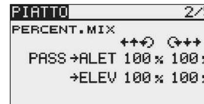
Di seguito si regolano i valori di miscelazione per le funzioni alet (ALET -> PASS). Si possono regolare valori percentuali separati per le escursioni verso destra o sinistra. Eseguire la regolazione facendo in modo che la funzione Roll non ostacoli quelle di Pitch o Nick lungo l'intera corsa.
