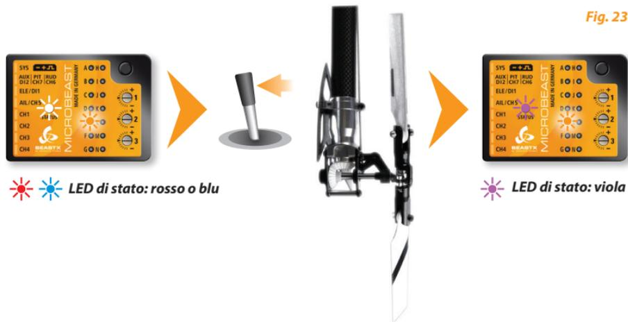
⚠ Se il colore del LED di stato non corrisponde a quelli sopra evidenziati, vuol dire che la corsa del servo è insufficiente. Montare la sferetta più lontana dal fulcro del servo.
